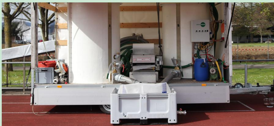
L'eau de lavage aspirée, est pompée dans une installation de nettoyage mobile. L'eau et la boue sont séparées dans un réacteur. Ce procédé est unique et n'est possible que grâce à un réactif spécialement développé.
