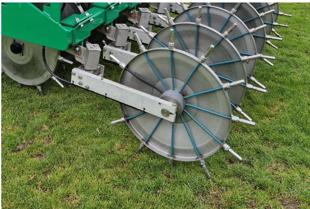
L'**injecteur de fluide de SWISS GREEN** est une machine permettant l'application de divers liquides directement dans le système racinaire des pelouses. La technique Cultan, bien connue dans l'agriculture, a été développée pour être employée sur les surfaces engazonnées.
