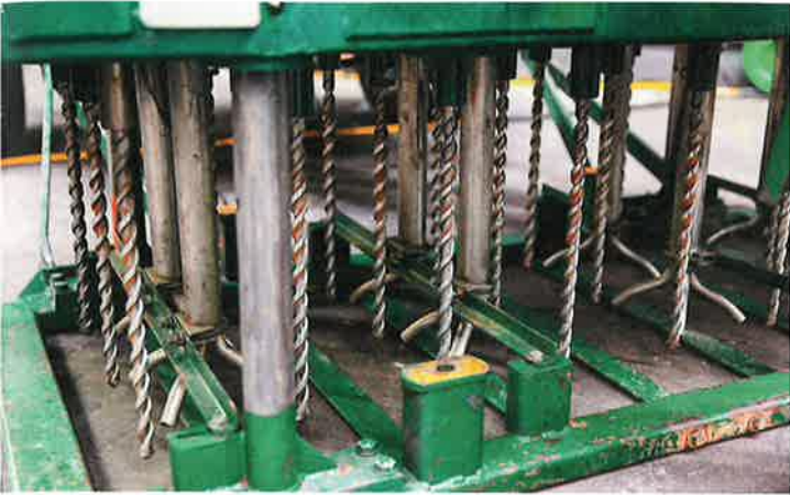
La machine Drill & Fill (haut et bas, à g.), unique en Suisse, permet de résoudre certains problèmes de drainage. La machine tractée Fluid Injector (haut, à d.) permet d'appliquer des solutions liquides, et d'utiliser immédiatement la surface après traitement. Fumures organiques pour gazons de golf et sport (bas, à d.).
